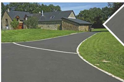
Plus traditionnel, l'enrobé noir à chaud s'associe facilement aux bordures et permet de réaliser des finitions personnalisées.
