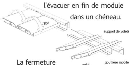
La fermeture du système procure alors un abri contre la pluie. Il n'est cependant pas conçu pour créer un espace clos, hermétique hors d'eau, isolé, dans le sens d'une pièce habitable (on reste dans le cadre d'une surface hors oeuvre brute).
